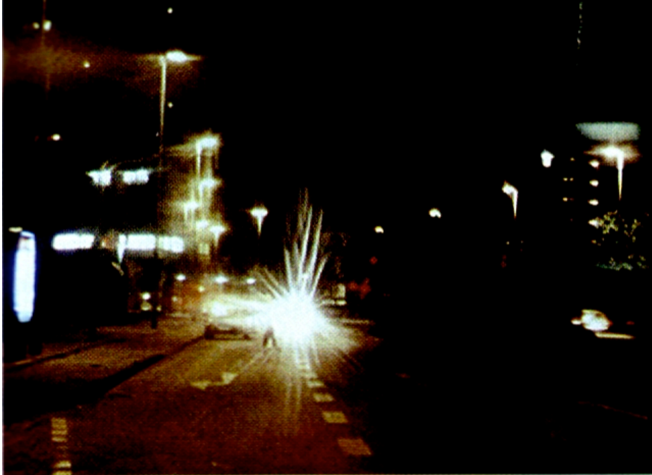
Vision au travers d'un pare-brise usé. Phénomène de diffraction. Piéton non visible
