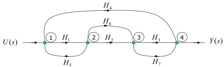
$$\frac{Y(s)}{U(s)} = \frac{H_1 H_2 H_3 + H_4 - H_4 H_2 H_6}{1 - H_1 H_5 - H_2 H_6 - H_3 H_7 - H_4 H_7 H_6 H_5 + H_1 H_5 H_3 H_7}$$
