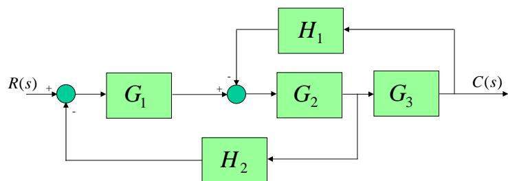
$$\frac{R(s)}{\frac{G_1 G_2 G_3}{1 + H_1 G_2 G_3 + H_2 G_1 G_2}} \rightarrow C(s)$$
